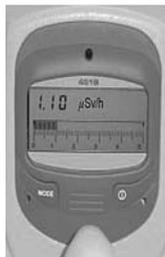
**Дозиметр 451В измеряет мощность дозы рентгеновского и гамма-излучения, регистрирует альфа- и бета-излучение\***
