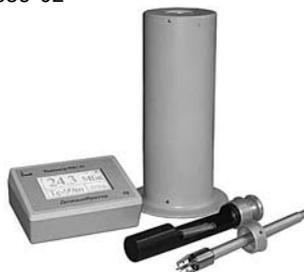
**Прибор настраивается на измерение активности любых имеющихся в наличии радионуклидов. Для экспонирования образцов большой активности в базовый комплект поставки входит специальный пенал для измерения шприцев
