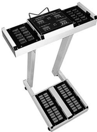
**Установка РЗБ-05Д проста в эксплуатации и удобна при проверке и ремонте, все блоки детектирования взаимозаменяемы, в блоках детектирования применяются общедоступные газоразрядные счетчики**
