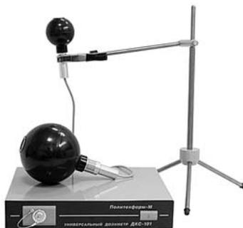
**Высокоточный широкодиапазонный дозиметр для лучевой терапии, клинической дозиметрии и метрологии ионизирующих излучений**
