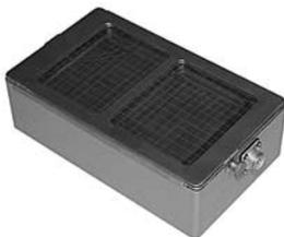
Подключенный к УИМ2-2Д, блок позволяет проводить оперативный контроль поверхностных снимаемых загрязнений и/или загрязнений рук персонала. Достаточно приложить к поверхности детекторного блока ладонь или мазок, чтобы оценить степень загрязненности
