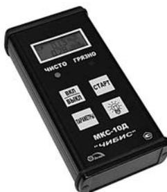
**Высококчувствительный прибор, обеспечивающий одновременное измерение гамма-фона и плотности потока бета-излучения. Корректно измеряет бета-загрязненность поверхностей даже в условиях высокого гамма-фона**
