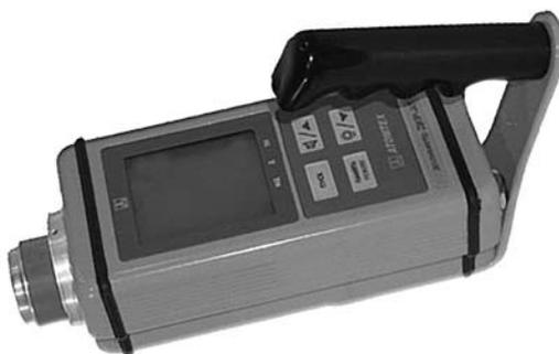
**Прибор для оперативного контроля дозовых нагрузок на хрусталик, слизистые оболочки и кожу, измеряющий мощность направленного эквивалента дозы рентгеновского излучения**
