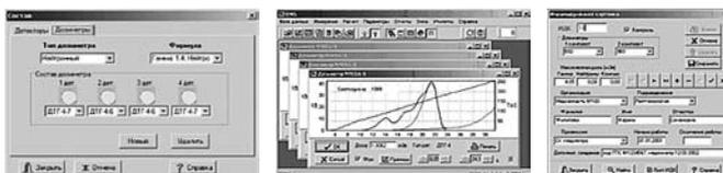
**Программа позволяет производить автоматический поиск пика, выбор границ интегрирования, при необходимости вычитание фона и аппроксимацию дозиметрического пика в случае, когда КТВ представляет собой суперпозицию нескольких пиков, из которых требуется выделить лишь один дозиметрический пик**
