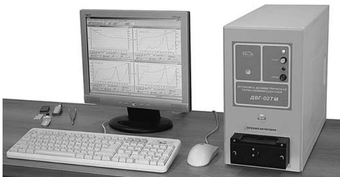
**Текущий индивидуальный дозиметрический контроль (ИДК) внешнего облучения рентгеновским, гамма- и нейтронным излучениями, а также определение доз в коже лица, хрусталике глаза и коже пальцев рук. Считывающее устройство установки совмещено с ПЭВМ**
