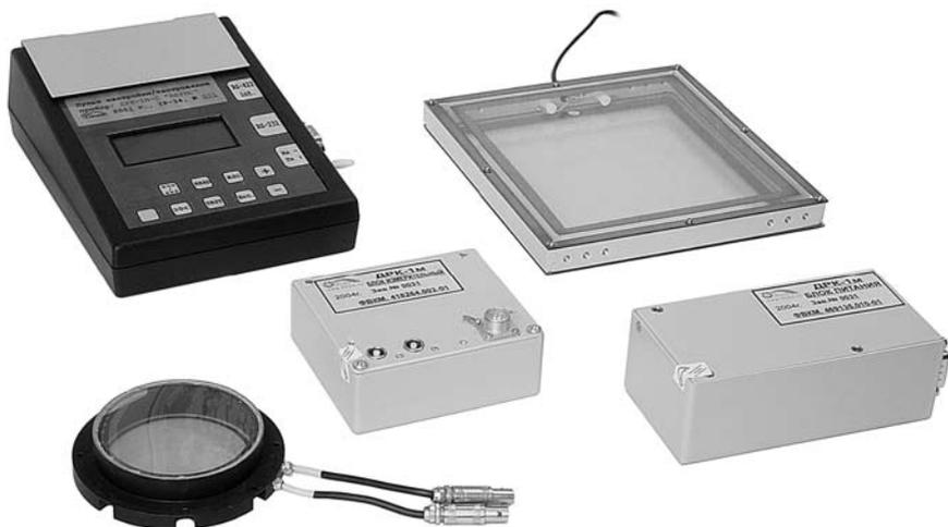
**Модернизация дозиметра ДРК-1 предназначена для определения доз облучения пациентов при проведении диагностики и оперативного мониторинга с использованием рентгеновских установок типа «С-дуга», применяемых в хирургии и ангиографии**
